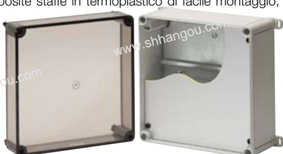
Il fondo della cassetta è predisposto per l'inserimento di piastre o guide din per l'installazione di morsettiero ed altri componenti, e in alcuni modelli è possibile l'installazione di una piastra superiore per montaggio di apparecchi. Il fissaggio è realizzato con inserti in ottone.
